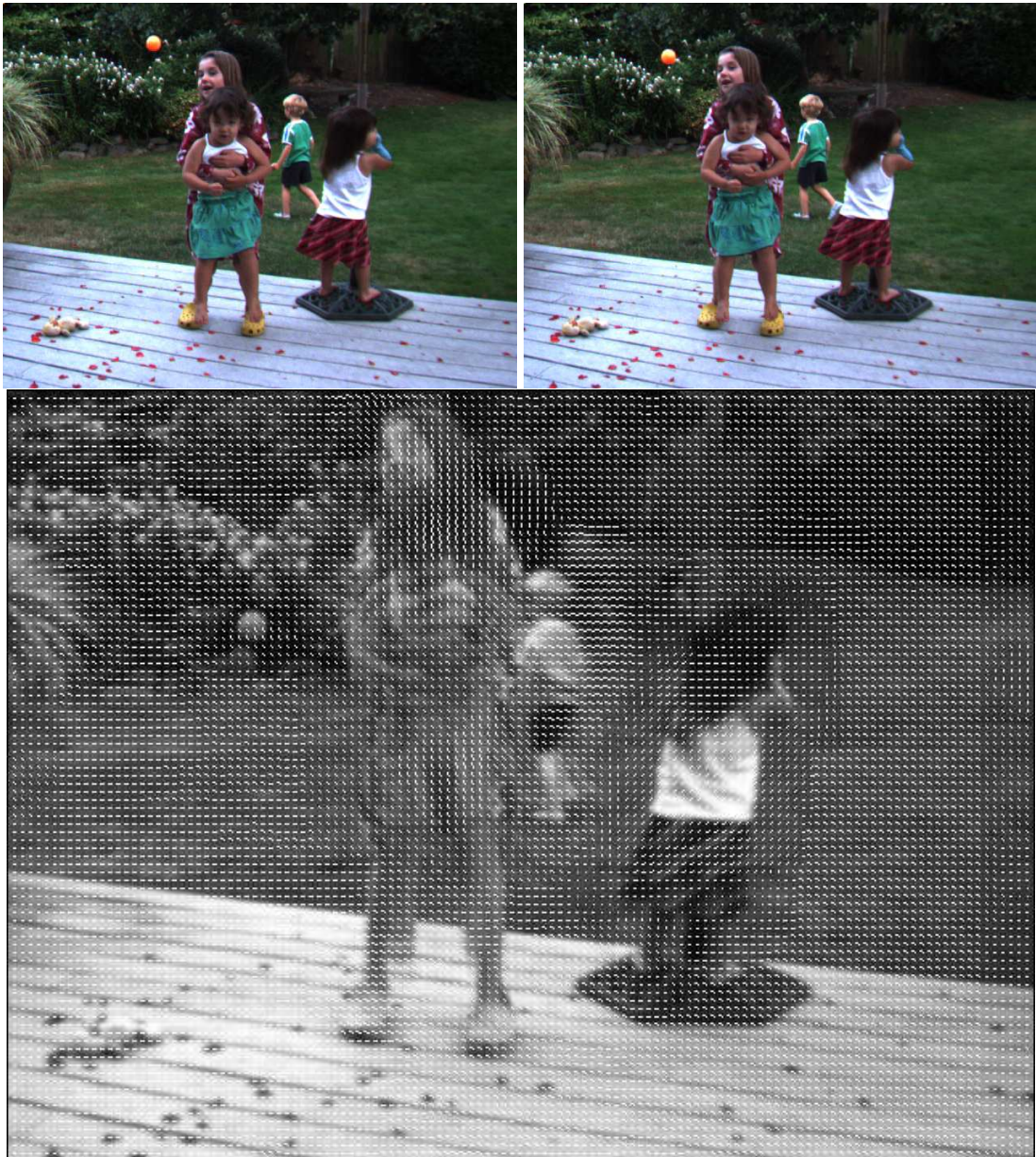
Figura 4.2: Exemplo do cálculo do fluxo óptico para a segunda sequência de imagens: (a) Primeira imagem da sequência. (b) Segunda imagem da sequência. (c) Fluxo óptico calculado.
