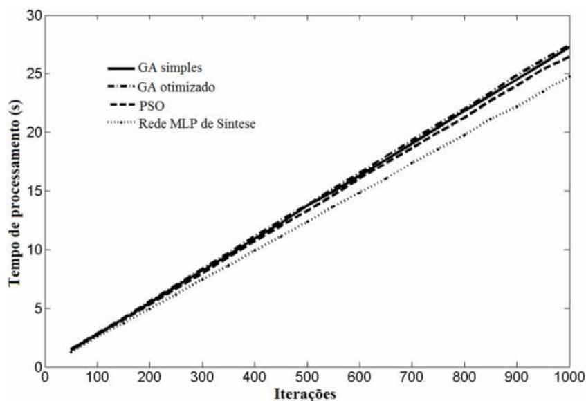
Fig. 5.63. Esforço computacional requerido pelas simulações dos algoritmos genéticos e PSO e pela rede MLP.
