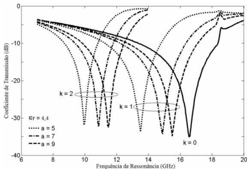
Fig. 5.37. Coeficientes de transmissão em dB da FSS com elementos fractais de Koch, analisada para os três níveis de iteração.
