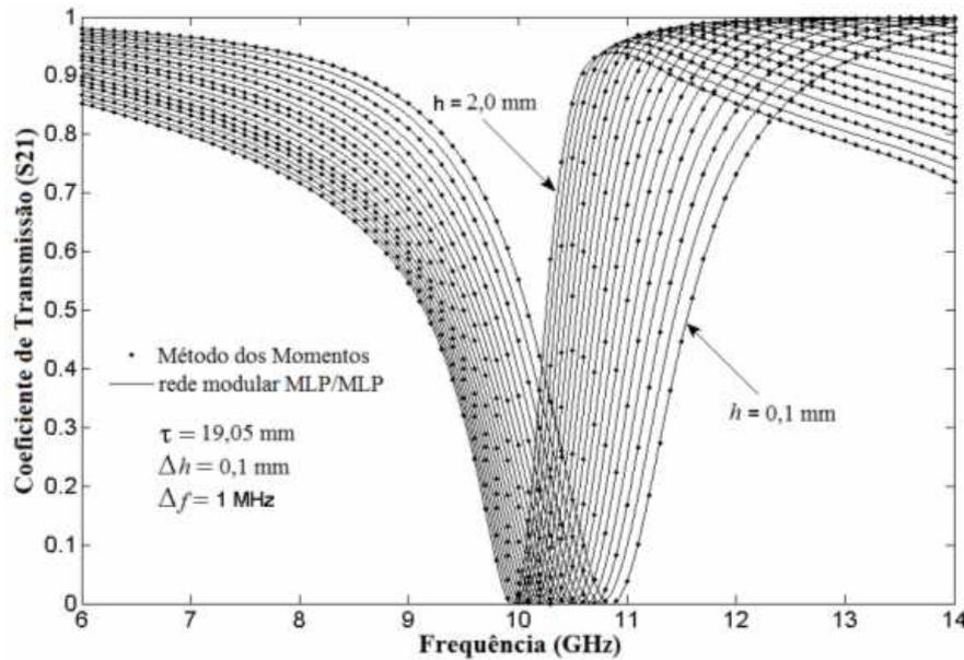
Fig. 5.56. Modelagem do coeficiente de transmissão  $S_{21}(f, h, \tau)$  pela rede modular MLP/MLP.
