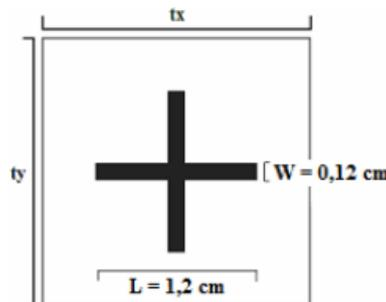
Fig. 5.1. Elemento de *patch* do tipo dipolo cruzado.
