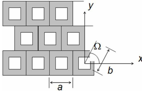
Fig. 2.2. Arranjo periódico genérico com elementos de abertura.
