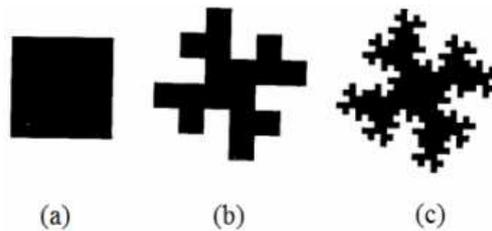
Fig. 3.8. Fractal *Quadric Koch* referente ao elemento gerador com  $D = 3/2$ : níveis (a) 0, (b) 1 e (c) 2.
