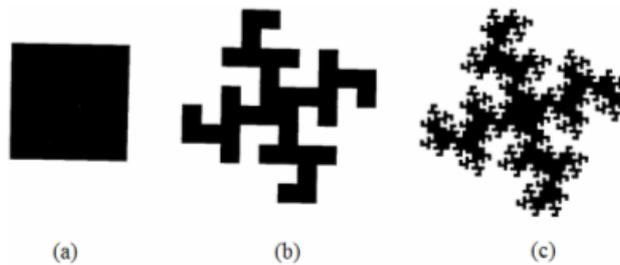
Fig. 3.9. Fractal *Quadric Koch* referente ao elemento gerador com  $D = 1,6131$ : níveis (a) 0, (b) 1 e (c) 2.
