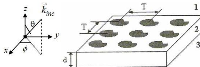
Fig. 1.1. Geometria de uma estrutura periódica bidimensional.
