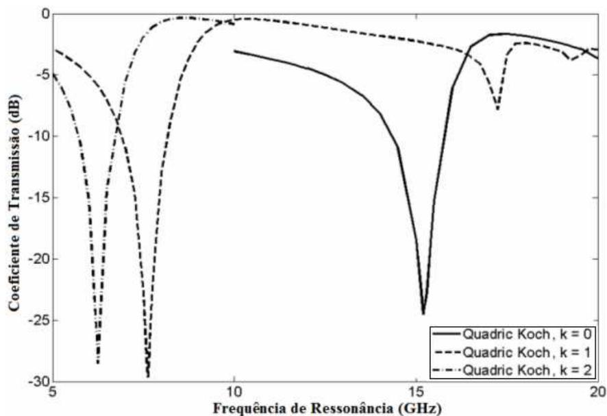
Fig. 3.18. Coeficiente de transmissão em dB para as FSSs de elementos fractais *Quadric Koch* com  $D = 1,6131$ .
