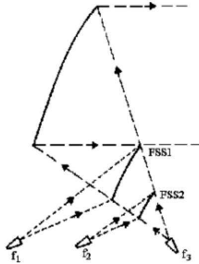
Fig. 1.6. FSS usada como antena refletora *offset*.
