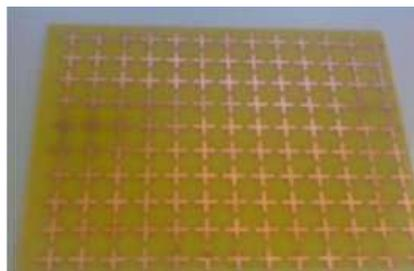
Fig. 5.7. Novo protótipo de FSS confeccionado:  $t_x = t_y = 1,5$  cm;  $w = 0,2$  cm;  $L = 1,2$  cm.
