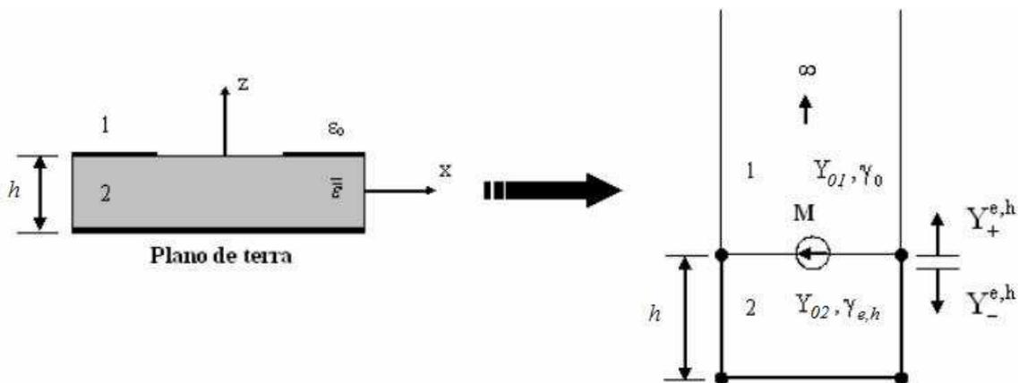
Fig. 2.6. Circuito equivalente utilizado na análise de uma FSS de abertura sobre camada dielétrica anisotrópica com plano de terra.
