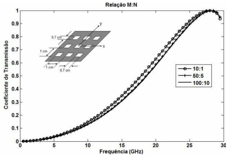
Fig. 2.9. Convergência da frequência de ressonância para uma FSS *freestanding* de elementos de abertura.
