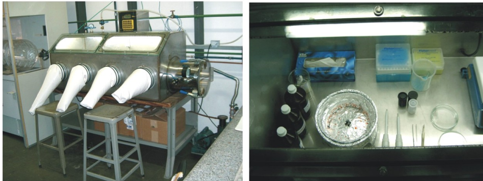
Figura 4.2: Câmara seca instalada em nosso laboratório para deposição das camadas poliméricas em ambiente inerte.
