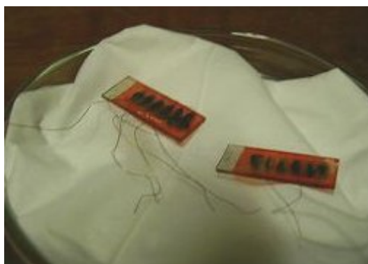
Figura 4.6: Aspecto final dos primeiros OLEDs fabricados no Departamento de Física da UFMG.
