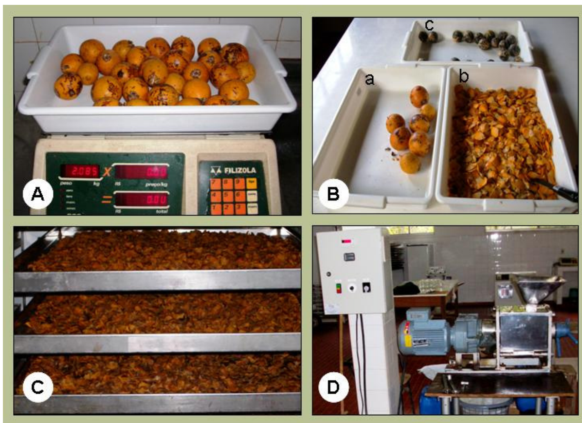
FIGURA 4 - Ilustração das etapas da metodologia: A) Pesagem dos trinta frutos; B) Despoldagem: a- frutos inteiros, b- polpa, c- castanha ou caroço; C) Secagem da polpa em estufa de ventilação forçada; D) Mini Prensa ERCITEC Modelo MPE-40 com adaptação para MTD 5 cv.
