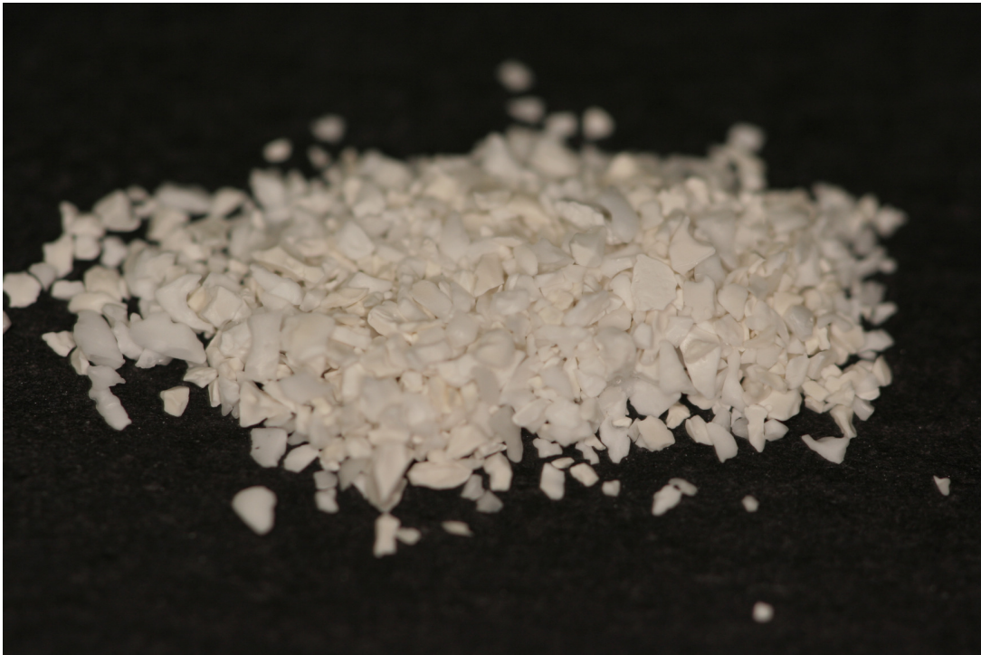
Figura 2 - Fotografia dos grânulos do Genphos ® , uma composição de HA (70%) e \beta -TCP (30%) com granulométrica de 0,50 - 0,75mm.
