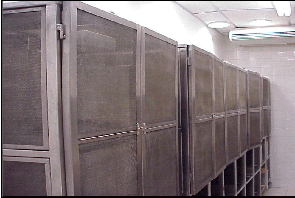
Figura 9: Ilustração das gaiolas de Faraday que são utilizadas para minimizar as influências eletrostáticas externas durante a aquisição do registro de sono.
