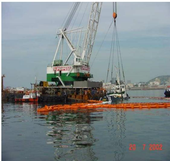
Foto 23 – Içamento do rebocador “DRACO”
