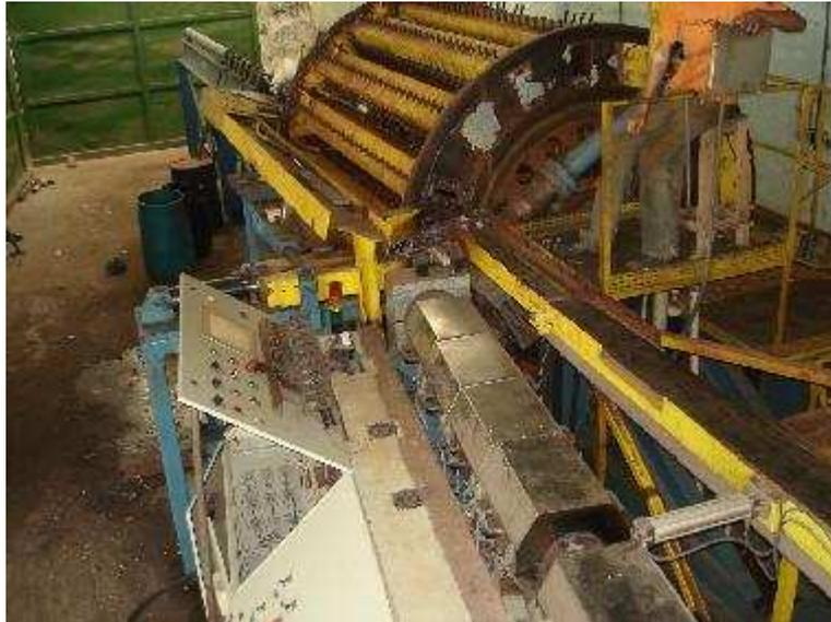
Figura III.13: Magazine “porta-moldes” e parte da Rosca.
