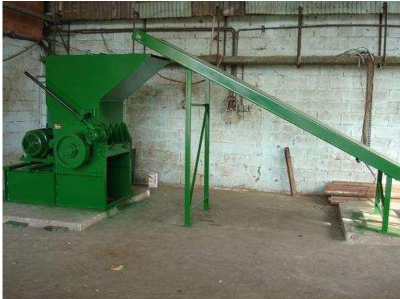
Figura III.26: Moinho de facas reformado e com esteira para alimentação
