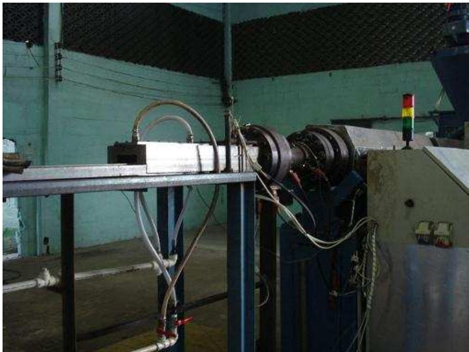
Figura III.19: Ponteira moldadora
