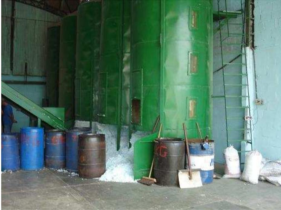
Figura III.24: Silos para a separação dos insumos
