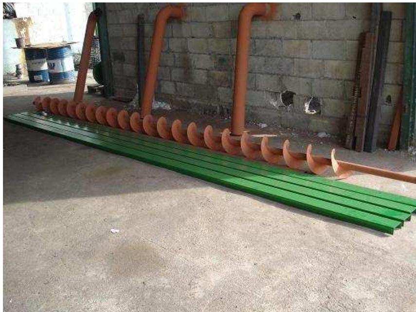
Figura III.27: Rosca interna do alimentador adensador/extrusora (em reforma)
