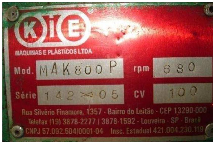
Figura III.7: Placa de identificação do motor do moinho de facas.
