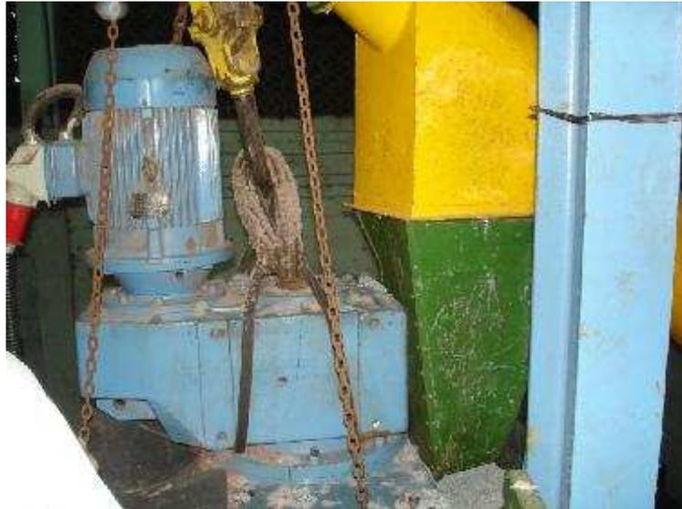
Figura III.11: Motor da rosca que alimenta a bacia da extrusora.
