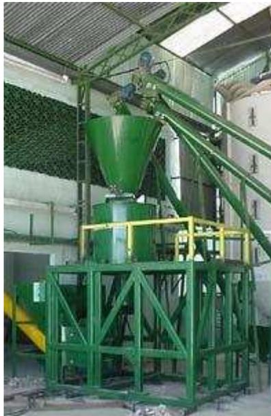
Figura III.10: Adensador Deutschsul, similar ao utilizado pela Ecowood Rio. (fonte: DEUTSCHSUL, 2008).
