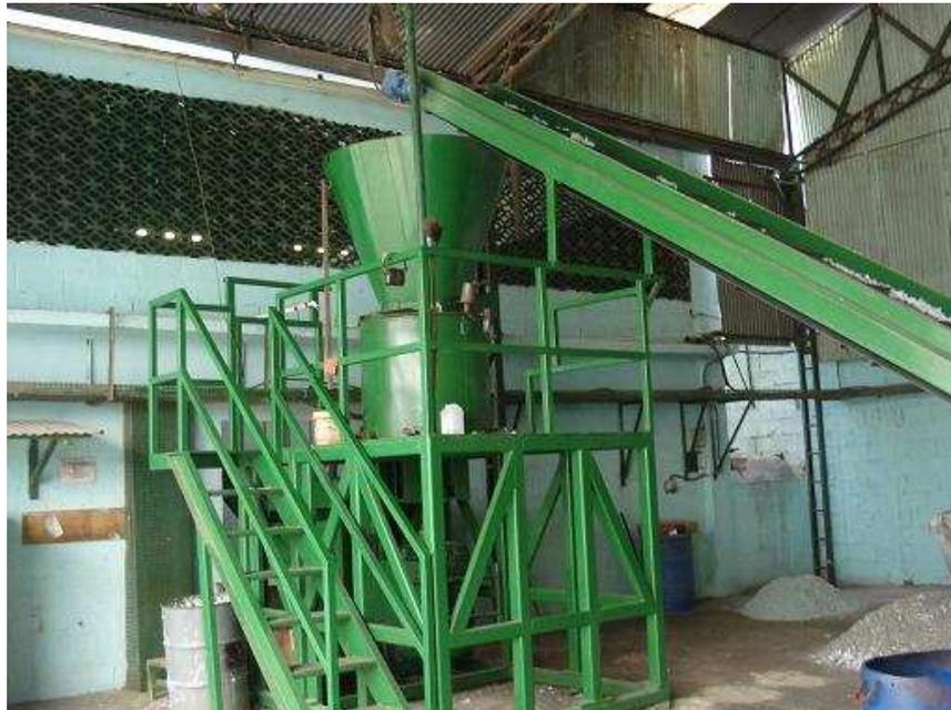
Figura III.25: Adensador após a reforma
