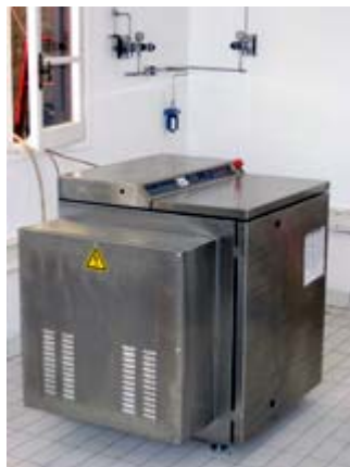
Figura 54: Célula de 5 KW de potência instalada no CRES
