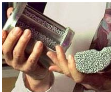
Figura 21: Hidrogênio armazenado na forma de hidreto metálico
