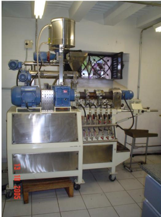
**Figura 1. Extrusora INBRAMAQ, modelo RXPQ Labor 24.**
