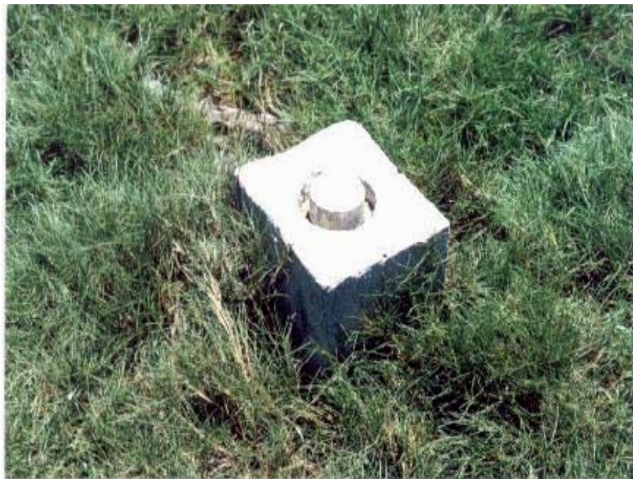
Figura 4.4. - Sistema de proteção do tubo utilizado
