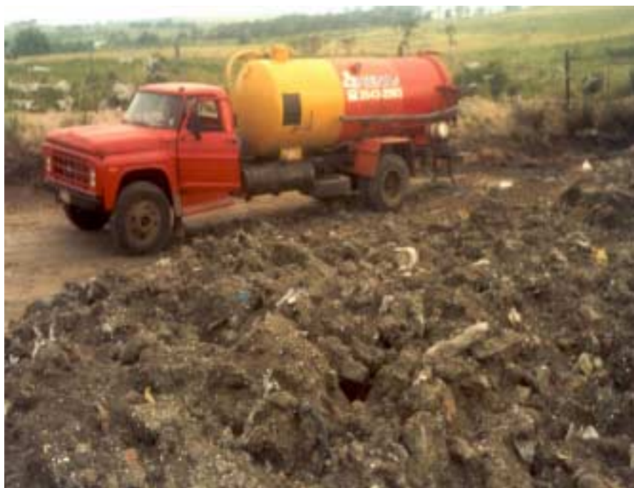
Figura 5.13. – Caminhão limpa fossa vazando esgoto na drenagem.
