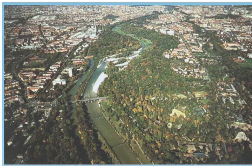
Figura 3.21 - Rio Isar, zona urbana de Munique (Alemanha). Preservação do leito maior, criando harmonia entre atividades de recreação e lazer, fauna e flora e controle de enchentes
