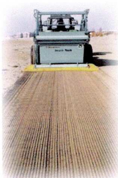
Figura 17 - Máquina de limpeza mecânica de areia de praia – 2.
