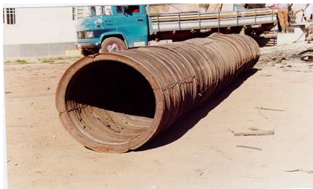
Figura 8 – Tubulação feita de pneus Fonte – Michelin (2000)
