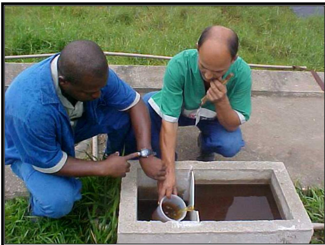
Foto 37 Medição da vazão do chorume.
