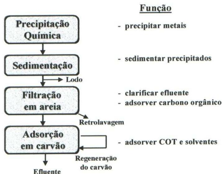
Figura 3 – Sequência de tratamento físico-químico (adaptado de McBean – 1995)
