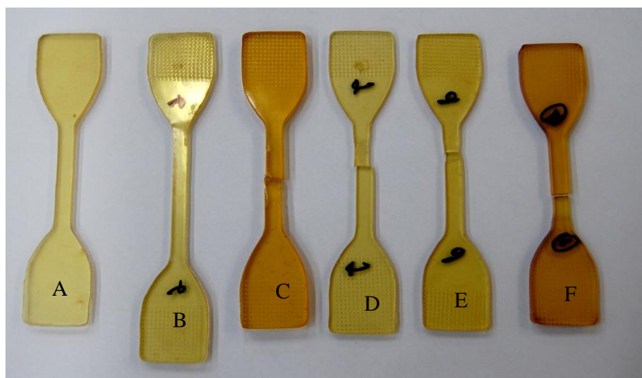
Figura 4.57 - Corpos de prova ensaiado no ensaio de tração (a) sem irradiar não ensaiado (b) sem irradiar ensaiado (c) Irradiado com UVA (d) irradiado com UVC (e) irradiado com gama dose de 25 kGy (f) irradiado com gama dose de 100 kGy
