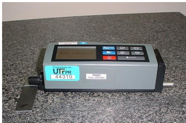
Figura 3.11 – Rugosímetro INSTRUTHERM RP 200, utilizado para determinação da rugosidade das peças de aço e alumínio
