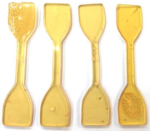
Figura 3.2 - Corpos de prova para ensaio de tração não adequados ao teste, por apresentarem bolhas
