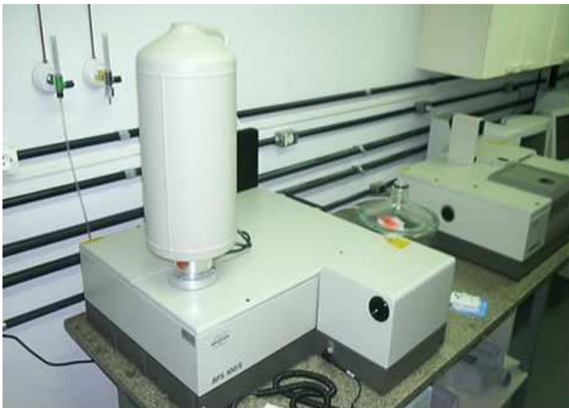
Figura 4.1 - Fotografia do espectrofotômetro FT-Raman
