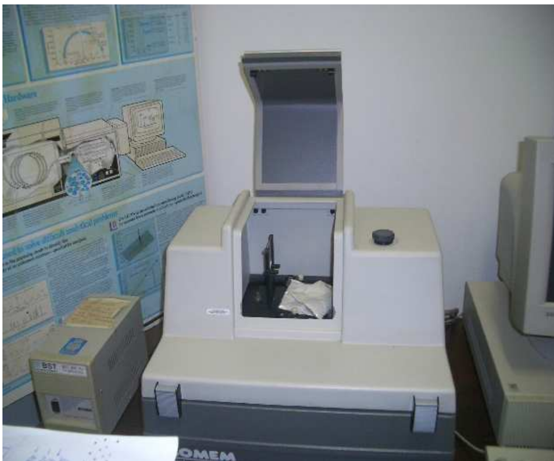
Figura 4.3: Fotografia do espectrofotômetro FT-IR
