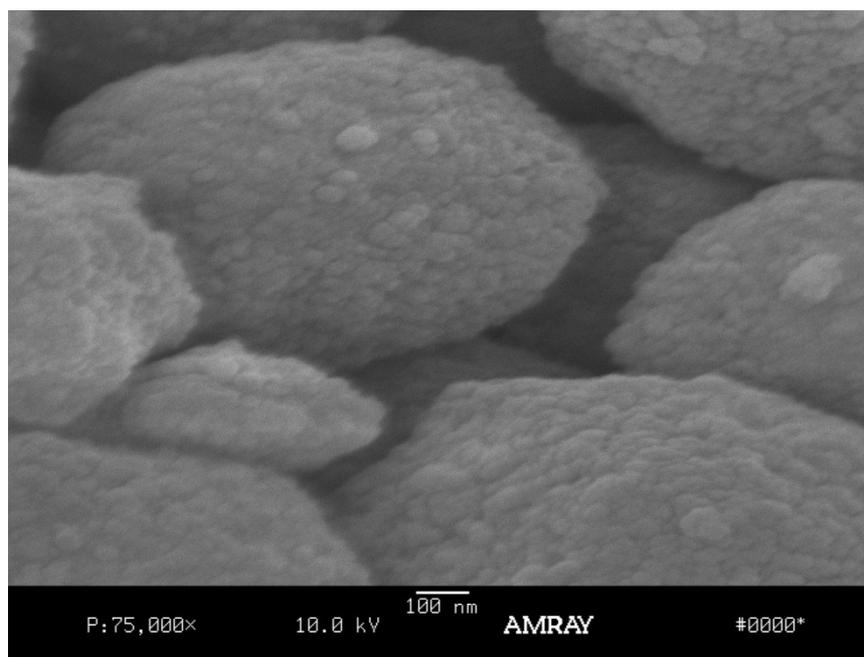
**FIGURA 8** – Aspecto morfológico do aglomerado de partículas de carga da resina composta Filtek Supreme D (X75000).
