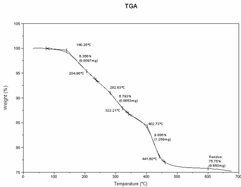
GRÁFICO 2 - Representação gráfica da análise termogravimétrica da resina composta Esthet X D, conteúdo de carga em peso (Wt%).
