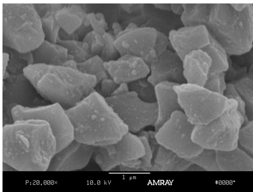
**FIGURA 4** – Aspecto morfológico das partículas de carga da resina composta Esthet X D (X20000).
