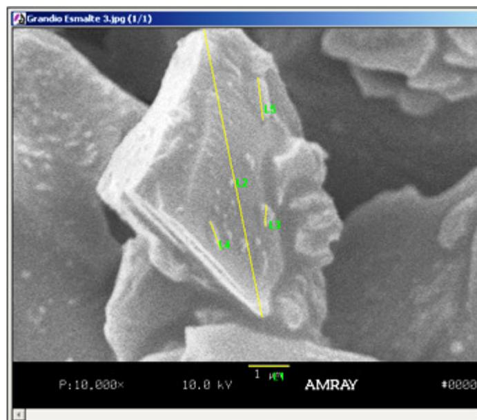
**FIGURA 2** - Figura ilustrativa do software Image Pro Plus 4.5.1 da aplicação da metodologia na medição do conteúdo inorgânico da resina Grandio E.
