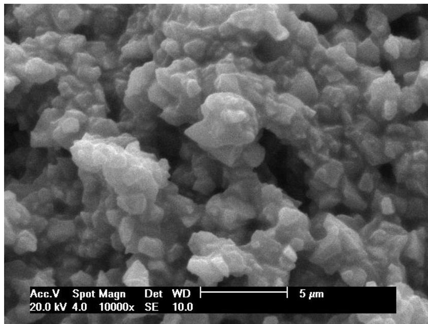
**FIGURA 5** – Aspecto morfológico das partículas de carga da resina composta Esthet X E (X10000).
