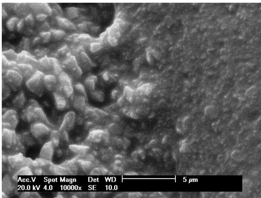
**FIGURA 6** - Aspecto morfológico das partículas de carga da resina composta Esthet X E (X10000).
