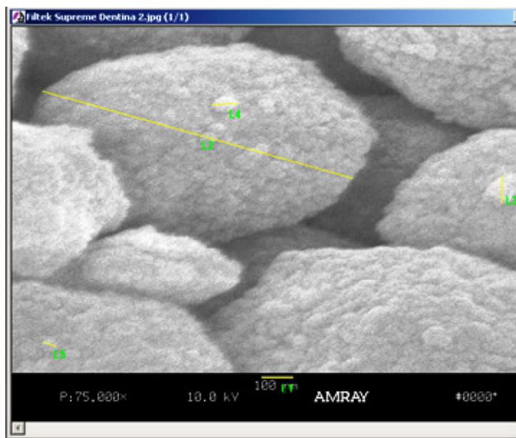
**FIGURA 1** - Figura ilustrativa do software Image Pro Plus 4.5.1 da aplicação da metodologia na medição do conteúdo inorgânico da resina Filtek Supreme XT D.
