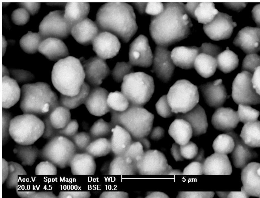
**FIGURA 7** – Aspecto morfológico do aglomerado de partículas de carga da resina composta Filtek Supreme D (X10000).
