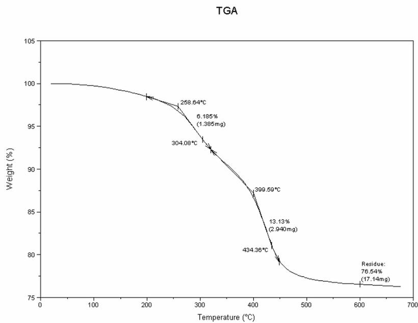
GRÁFICO 4 - Representação gráfica da análise termogravimétrica da resina composta Filtek Supreme D, conteúdo de carga em peso (Wt%).
