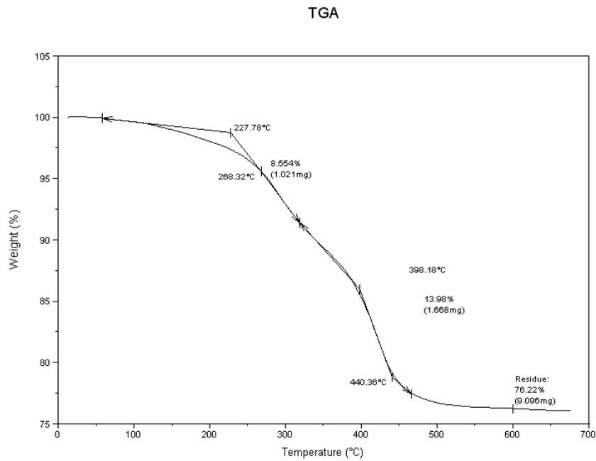
GRÁFICO 3 - Representação gráfica da análise termogravimétrica da resina composta Filtek Supreme E, conteúdo de carga em peso (Wt%).
