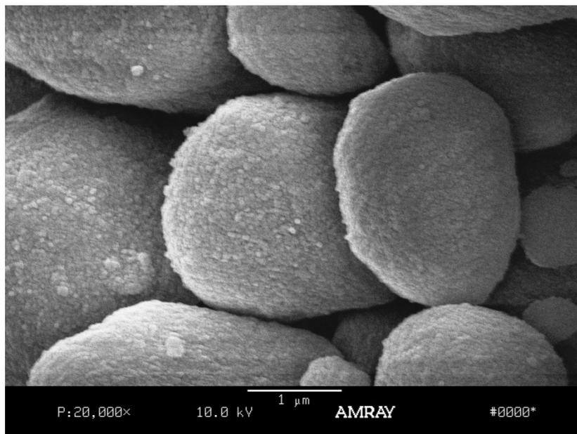
**FIGURA 9** – Aspecto morfológico do aglomerado de partículas de carga da resina composta Filtek Supreme E (X20000).
