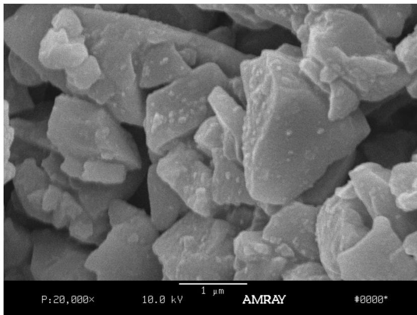
**FIGURA 3** – Aspecto morfológico das partículas de carga da resina composta Esthet X D (X20000).
