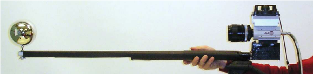
Figura 3: Equipamento para aquisição de imagem HDR - esfera espelhada de 10 cm diâmetro e video-gravadora digital
