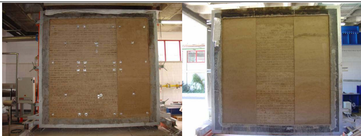
Fig. 34 – Faces externa (esq.) e interna (dir.) de parede executada em pórtico de equipamento para ensaio de resistência ao fogo do Laboratório de Estruturas e Resistência ao Fogo – LERF, Aveiro – Portugal.
