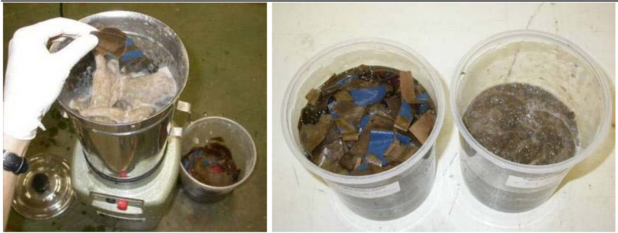
Fig. 4 – Trituração do papel em liquidificador industrial (esq.); Kraft fragmentado de molho e polpa de celulose ao final do processo (dir.).
