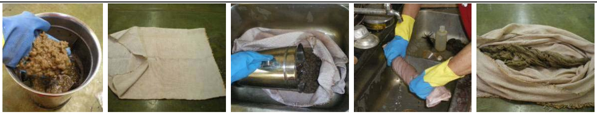
Fig. 9 – Polpa de celulose no liquidificador industrial; Bobina geotextil; Colocação da polpa na bobina geotextil; Retirada do excesso de água com a torção manual da bobina; Polpa sem o excesso de água.
