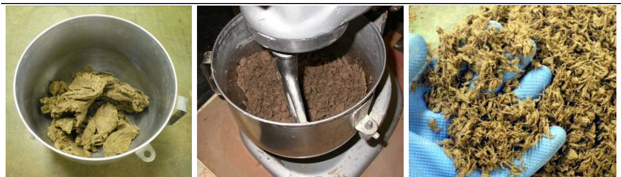
Fig. 12 – Polpa de celulose sem o excesso de água; Dispersão das fibras na argamassadeira; Fibras dispersas.
