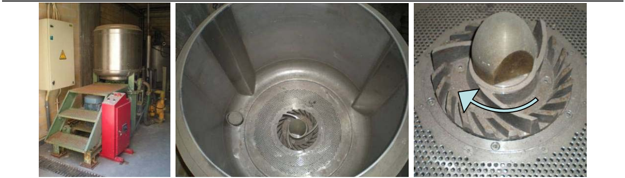
Fig. 7 – Misturador de papel da RAIZ / Vista do interior do tanque / Detalhe da hélice com sentido de rotação.
