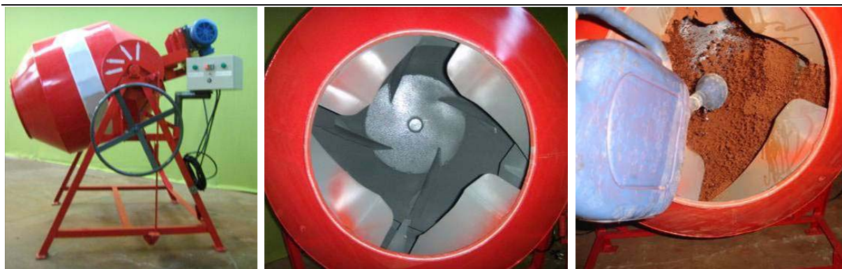
Fig. 2 – Misturador para solos com pás que evitam a formação de grumos (Fonte: Eco Máquinas).
