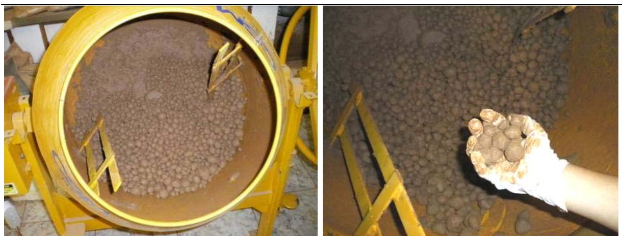
Fig. 17 – Formação de grumos em mistura de Kraftterra em uma betoneira.
