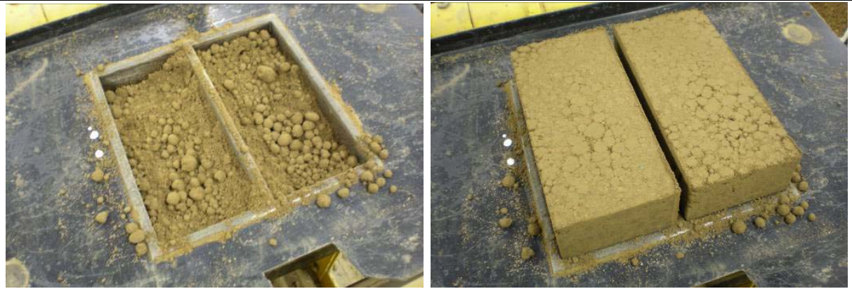
Fig. 18 – BTCs produzidos com mistura de Kraftterra que apresentava grumos.
