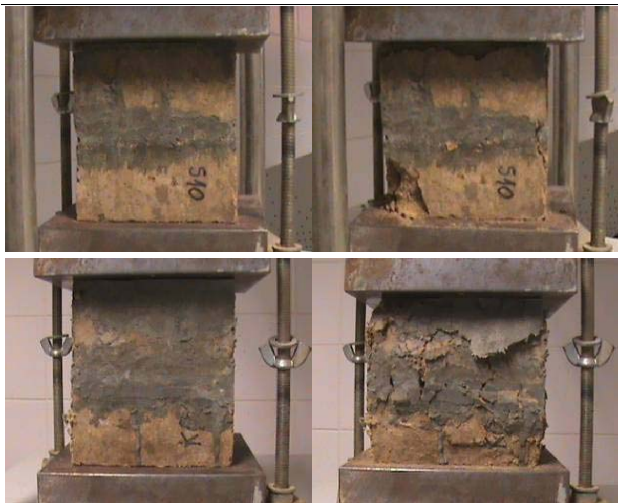
Fig. 44 - CPs de BTCs de Kraftterra (abaixo) e solo-cimento (acima) no início e ao final dos ensaios de resistência à compressão simples.
