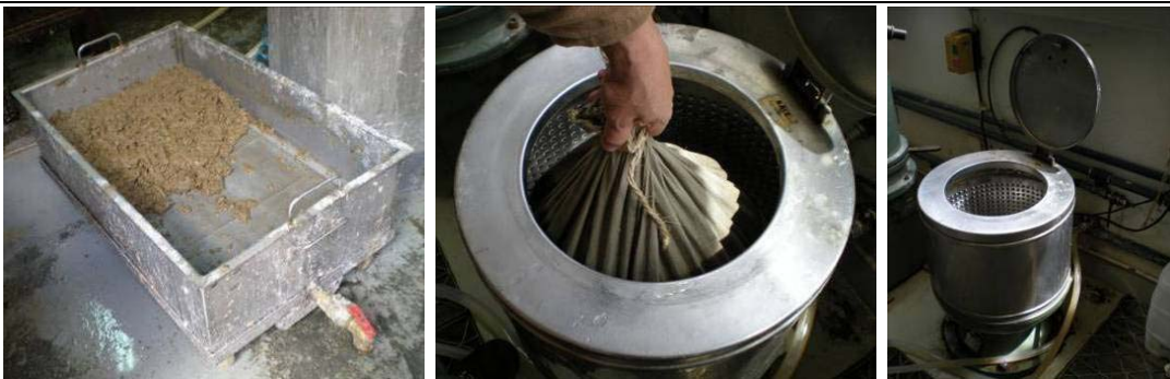
Fig. 10 – Recipiente com peneira metálica e dreno com válvula (esquerda); Saco de lona crua com polpa ainda com excesso de água sendo colocado na centrífuga (centro); Centrífuga de eixo vertical (direita)
