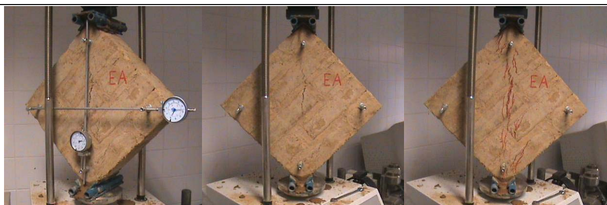
Fig. 55 – Prisma de Kraftterra que passou por ciclos de envelhecimento acelerado após ensaio de resistência à compressão diagonal.
