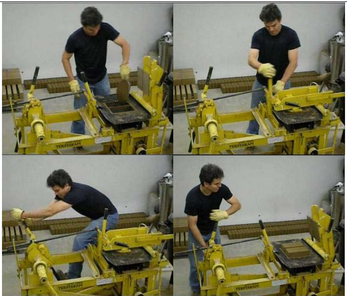
Fig. 21 – Compactação de BTCs em prensa manual TERSTARAM, no laboratório do DECivil/UA.
