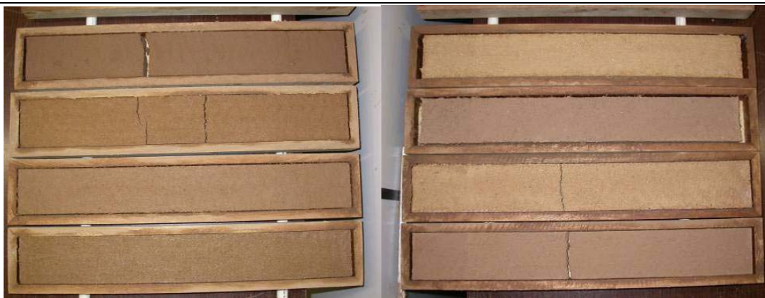
Fig. 36 – Ensaios da Caixa com solos corrigidos com areia. CPs sem fibras de papel Kraft apresentaram fissuras.
