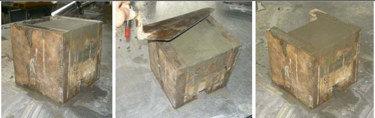
Fig. 23 – Regularização das faces de corpos-de-prova de BTCs.
