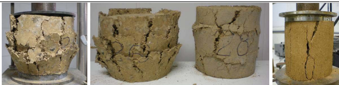
Fig. 40 – CPs cilíndricos de Kraftterra (esquerda e centro) e de solo-cimento (direita) após o final dos ensaios de compressão simples. Imagem da esquerda CPA-026. Imagem do centro CPA-026 (esq.) e CPA-028 (dir.)
