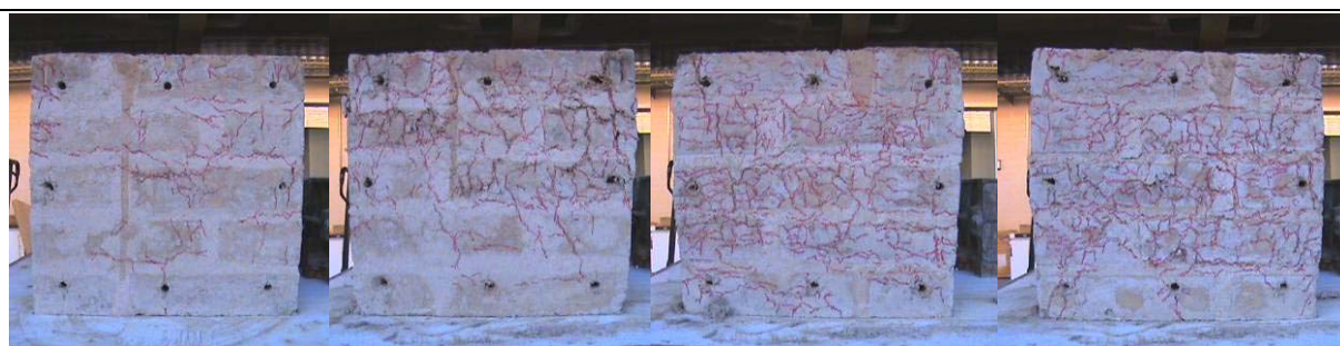
Fig. 49 – Prismas de Kraftterra após ensaios de resistência à compressão simples. As fissuras foram ressaltadas com tinta vermelha diretamente nos prismas.
