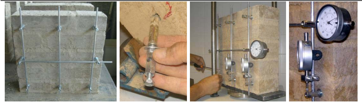
Fig. 29 – Sistema de fixação e apoio de extensômetros em prismas para ensaios de compressão simples.
