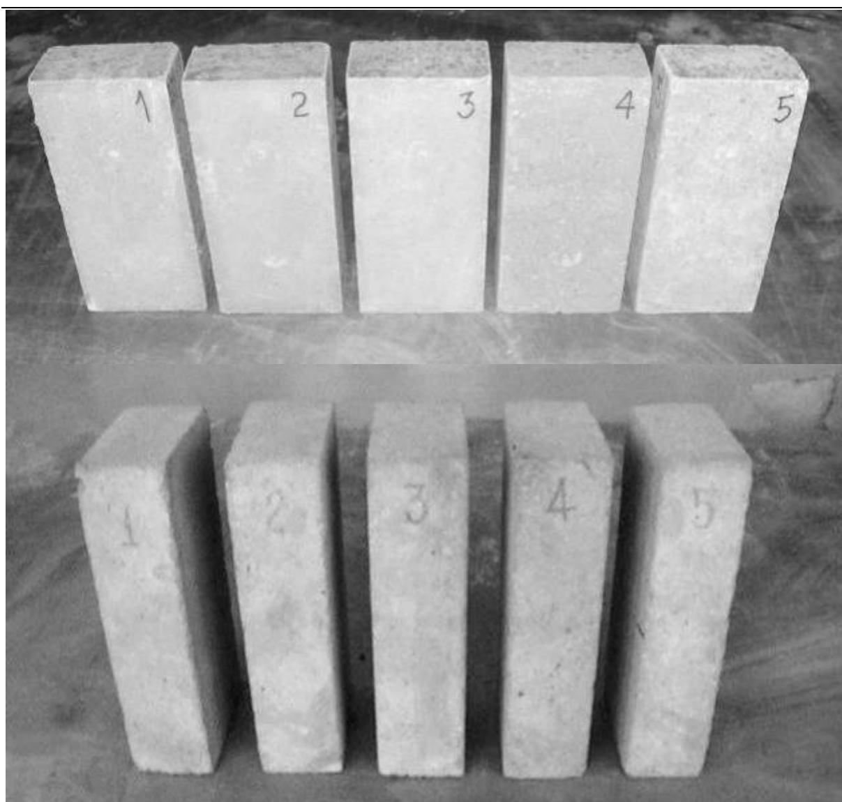
Fig. 45 - BTCs de solo-cimento (1 a 5) antes (acima) e depois (abaixo) dos ensaios de envelhecimento acelerado.
