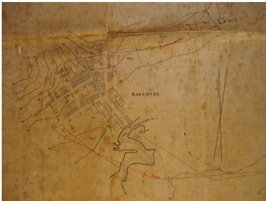
Fig. 25 – Mapa de modificação do ramal do Ceará-Mirim na altura de Macaíba. (1883) O trajeto original (em vermelho) contornava a cidade e cruzava o rio acima do porto do rio Jundiá. Pelo novo trajeto (tracejado) o acesso ao porto da cidade seria bloqueado. Fonte: Arquivo Nacional, Ministério dos Transportes, Caixa 4B-217.
