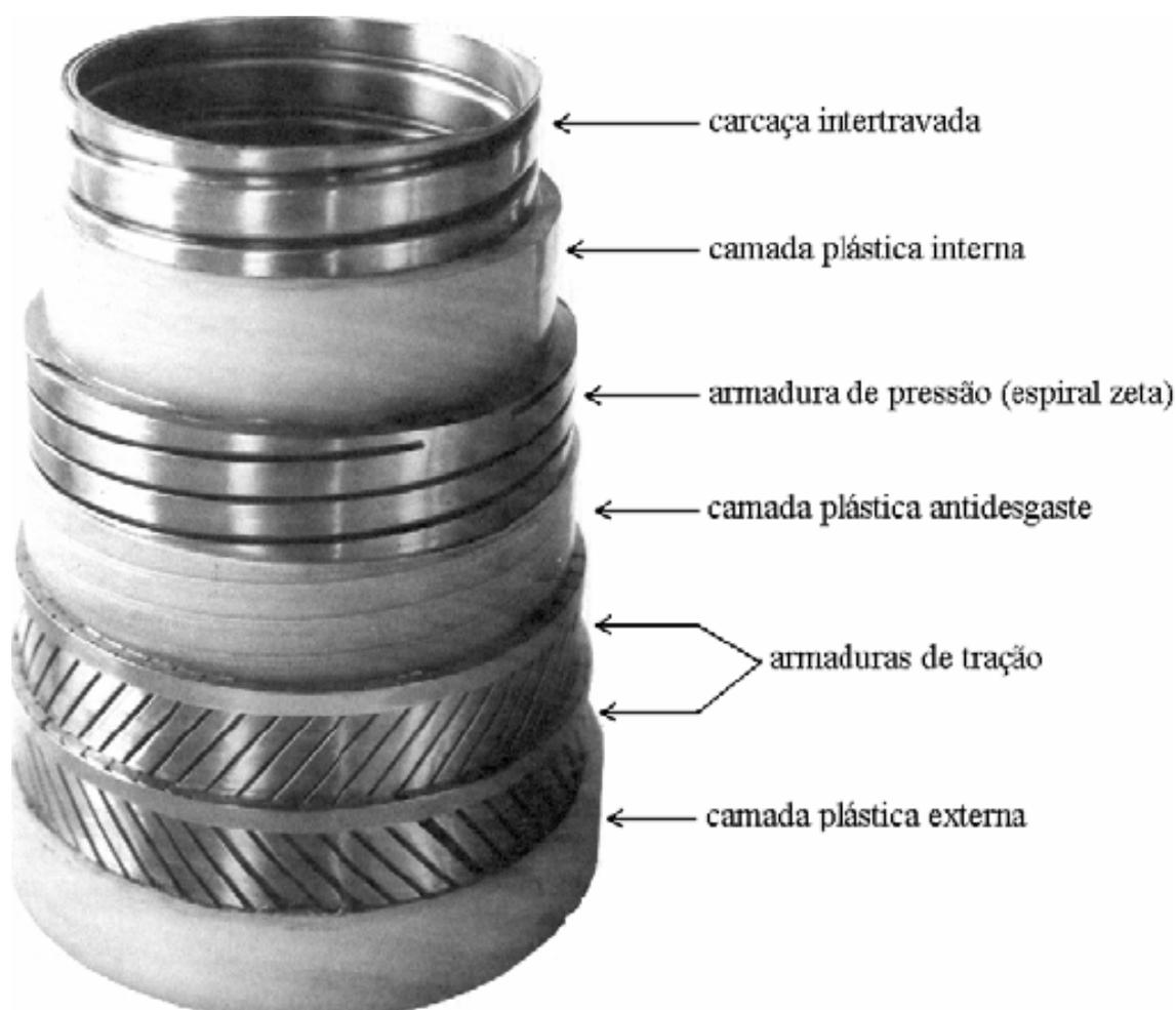
Figura 1.18: Estrutura típica de uma linha flexível
