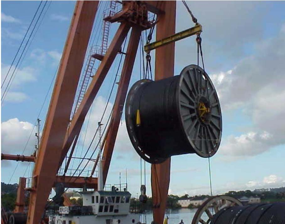
Figura 1.5 (b): Bobina para armazenamento de linhas flexíveis – Com linha flexível.
