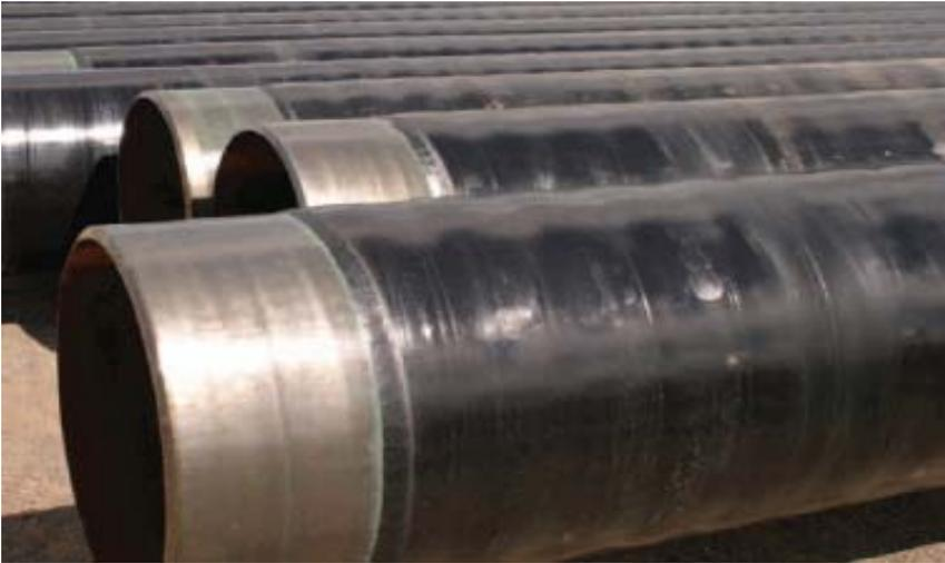
Figura 1.1: Revestimento Térmico
