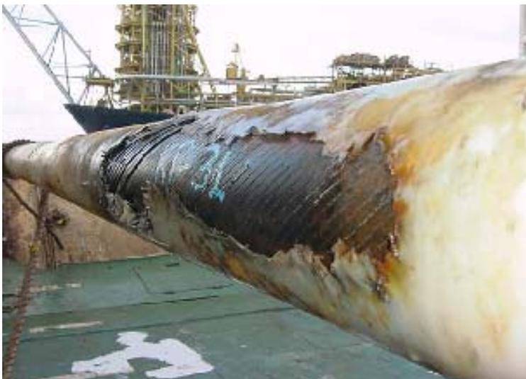
Figura 1.26: Abrasão da camada plástica externa
