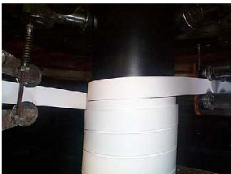
Figura 1.24 (a): Soluções para isolamento térmico - Aumento de espessura da camada externa
