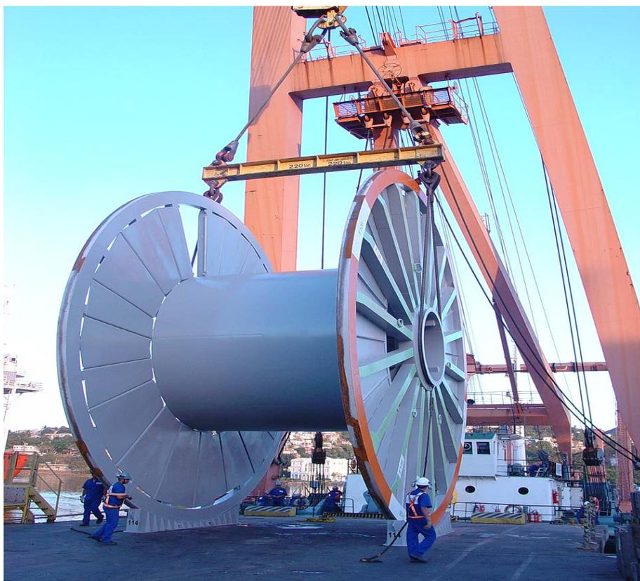
Figura 1.5 (a): Bobina para armazenamento de linhas flexíveis – Sem linha flexível.
