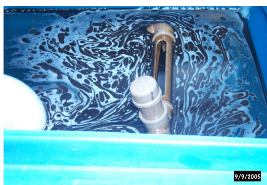
Figura 8.96 - Processo de emulsão oleosa formada no SAO devido à aplicação do detergente automotivo.
