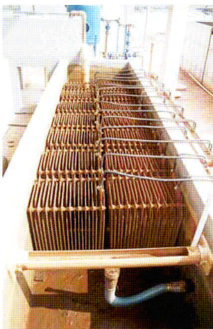
Figura 5.24 – Sistema de calhas eletrolíticas. Fonte: Tratamento e controle de efluentes industriais. Giordano, G., 2004.
