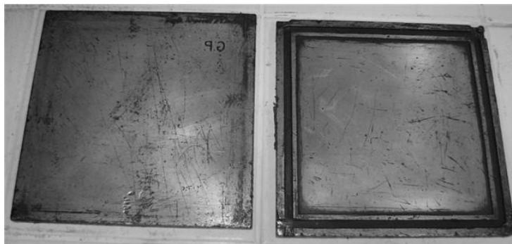
Figura 3.5: Moldes usados para confeccionar “tapetes” de elastômeros.
