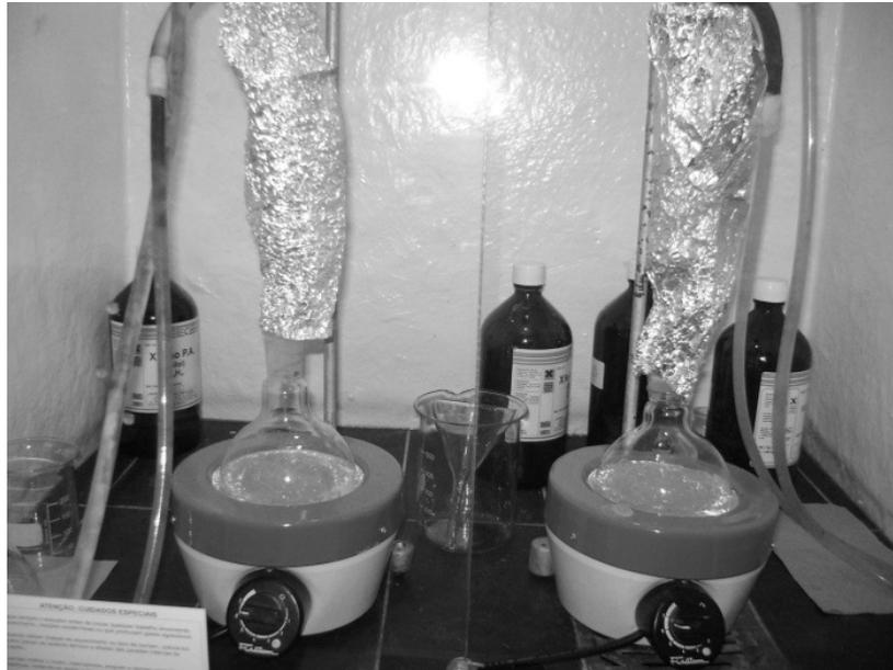
Figura 3.8: Equipamento e vidrarias usadas no ensaio de teor de gel.
