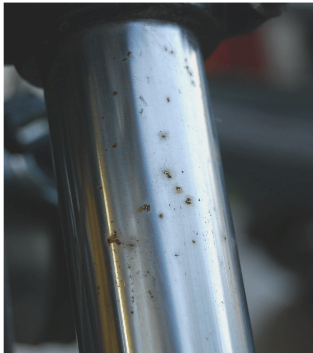
Figura 1.1: Aspecto de uma típica corrosão por pites (KAWASAKIMOTORCYCLE, 2009)
