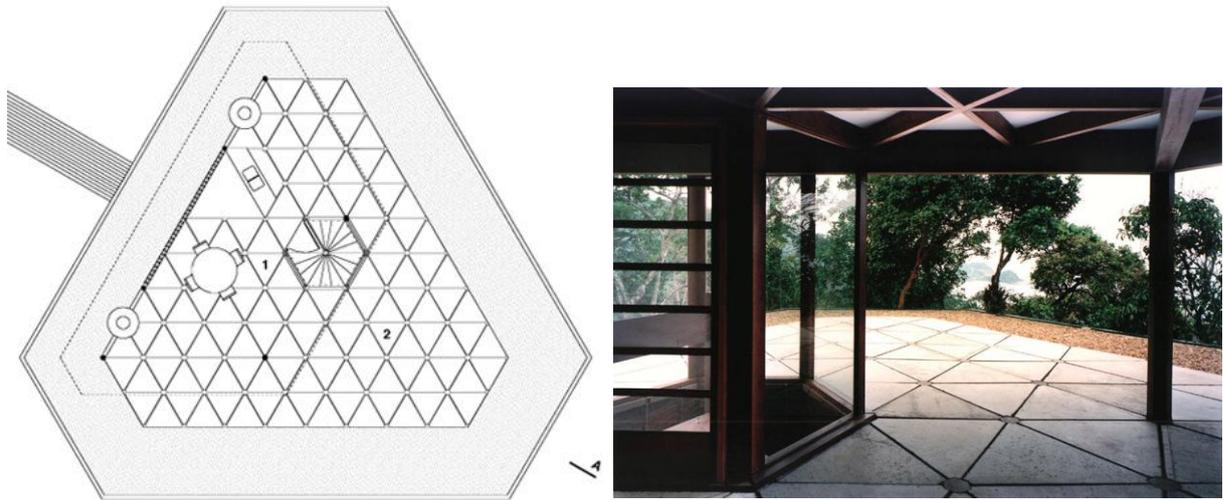
**FIGURA 77: Planta baixa da cobertura e Vista interna do mesmo pavimento. Residência Acayaba, Arq. Marcos Acayaba.** (Fonte: Arquivo pessoal do arquiteto)
