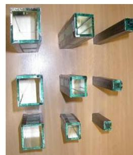
**Ilustração 44.** Foto dos dutos construídos – modelo em escala reduzida.
