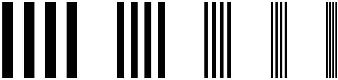
Figura 3.2 - Conjunto de pares de linhas com diferentes espaçamentos para avaliação do poder de resolução de um aparelho radiológico (CURRY III et al. , 1990).
