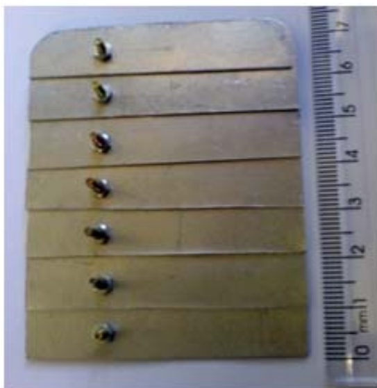
Figura 7.24 - Simulador de sensitometria desenvolvido para determinação da curva sensitométrica.
