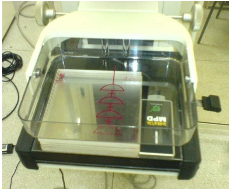
Figura 7.17 - Simulador de espalhamento posicionado no equipamento mamográfico para obtenção da imagem uniforme para o cálculo do NPS
