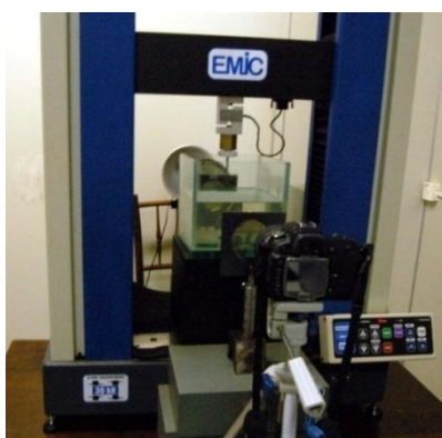
Fig. 9: Máquina de Ensaio Universal (EMIC – DL 3000), acoplado o polariscópio circular.
