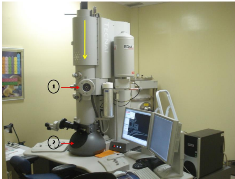
Figura 3.6: Microscópio eletrônico de transmissão Tecnai G 2 Spirit. A seta amarela na coluna vertical indica a direção do feixe de elétrons que incide sobre a amostra em 1. Em 2, a chapa fotográfica para visualização das imagens (CETENE).
