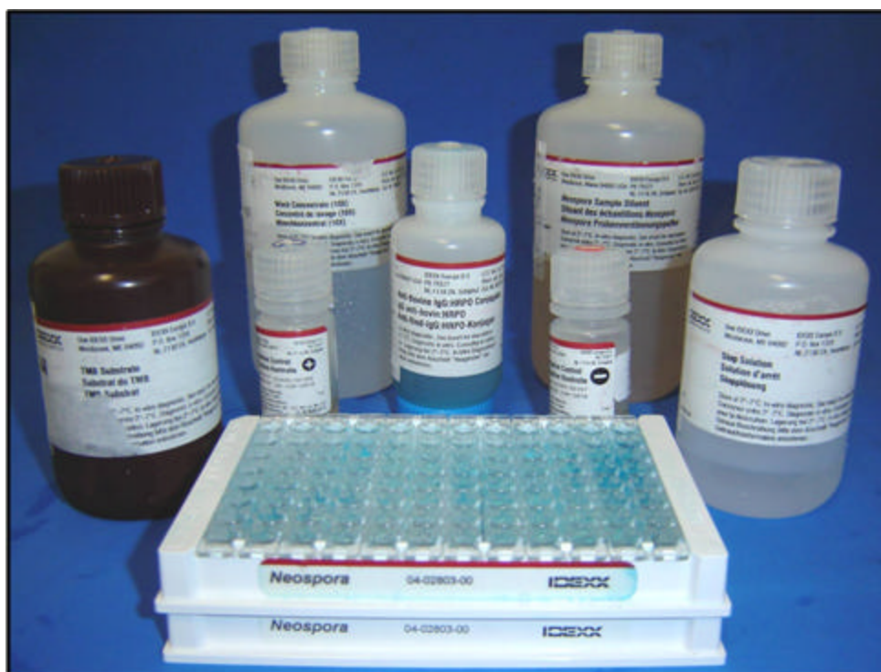
Figura 2 – “Kit” ELISA (Herdcheck®, IDEXX Laboratories Inc. EUA), para detecção de anticorpos anti- N. caninum em ruminantes.
