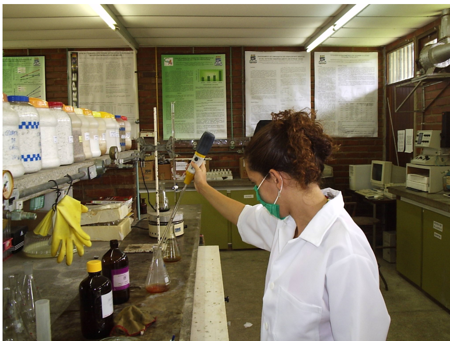
Figura 7 – Determinação do teor de carbono no Laboratório de Química Vegetal da UFRPE
