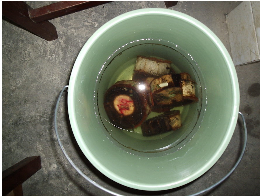
Figura 5 – Discos do tronco submersos em água em um recipiente tipo balde para determinação da densidade
