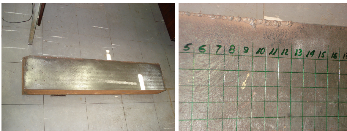
Figura 3.8 – Fotos da superfície pronta da peça para o ensaio ultrassônico.
