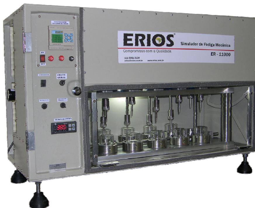
FIGURA 5 – Vista frontal da máquina simuladora de fadiga mecânica.
