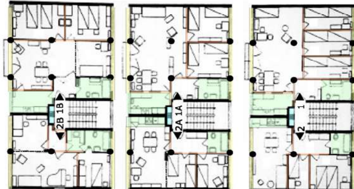
Figura 7 Fragmento da Planta do Pav. Tipo Alternativas 2B, 1B, 2A, 1A, 2 e 1.
