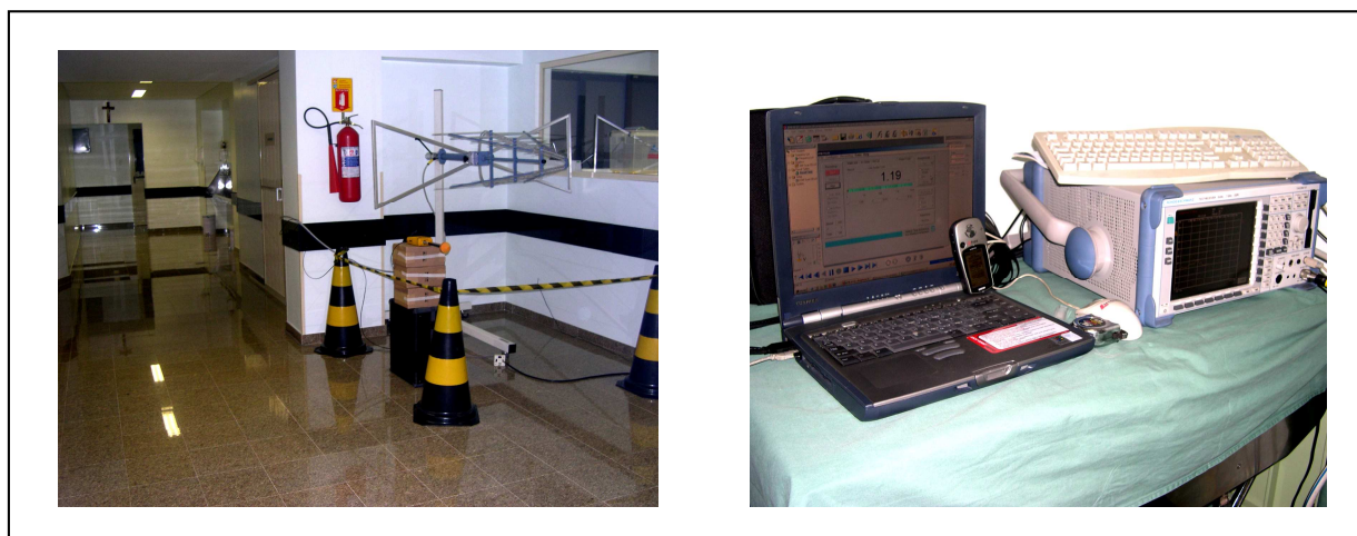
Figura 7. Local da instalação das antenas no centro cirúrgico apresentando a antena seletiva, a sonda isotrópica conectada ao medidor de campo isotrópico, o receptor/analizador de sinais de radiofrequência, notebook e um GPS.
