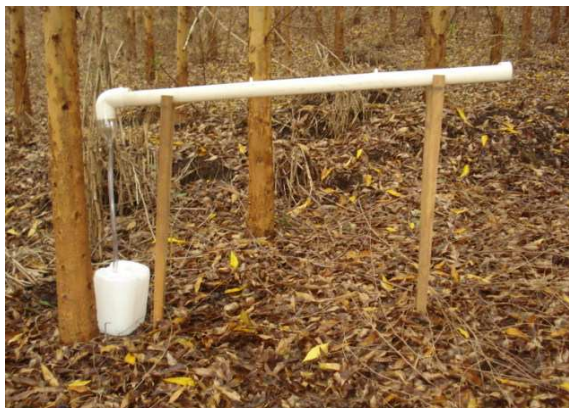
Figura 6. Foto do coletor de precipitação interna
