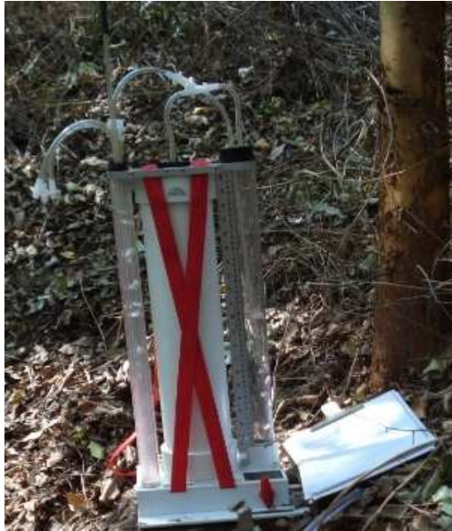
Figura 14. Permeômetro de carga constante utilizado para determinação da condutividade hidráulica do solo saturado
