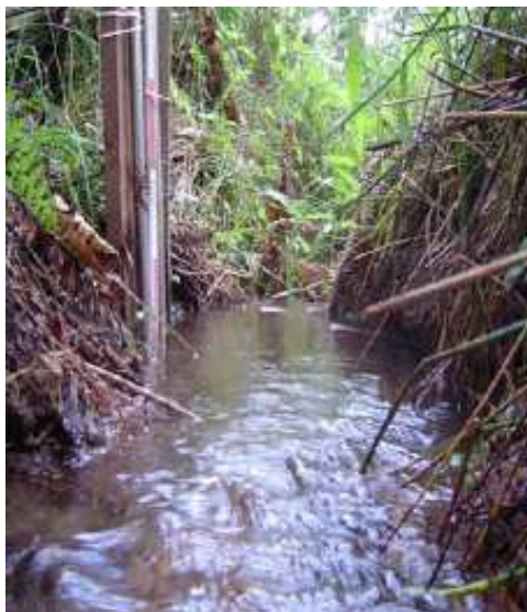
Figura 12. Canal da microbacia, com o registrador eletrônico de nível de água
