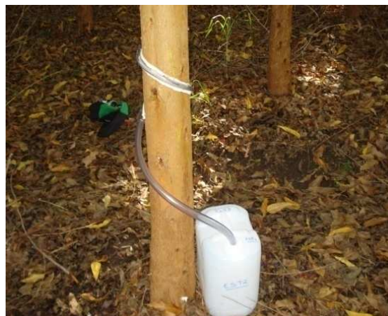
Figura 7. Foto do coletor do escoamento pelo tronco
