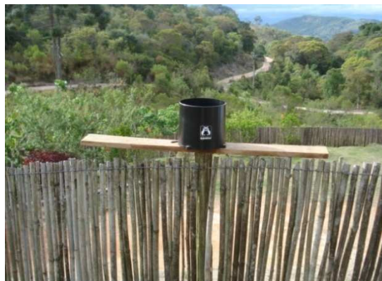
Figura 5. Foto do pluviógrafo instalado na microbacia.
