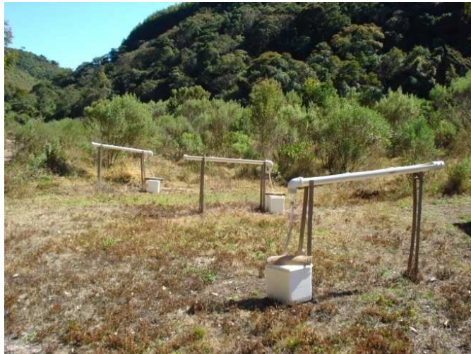
Figura 15. Coletores de chuva localizados ao lado da microbacia
