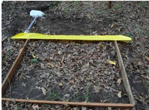
Figura 8. Foto da parcela para medida de escoamento superficial e galão de 20 litros.
