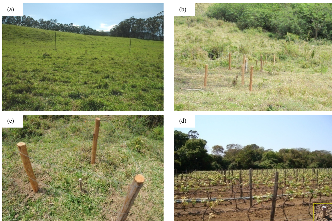
Figura 8. (a) Área de drenagem para instalação dos extratores de solução do solo na pastagem, vista a partir do ribeirão Cachoeira (b) Detalhe da zona ripária com pastagem na área de drenagem na pastagem e os extratores alinhados na zona ripária (c) Detalhe do extrator de solução no solo protegido por arame farpado (d) Área de drenagem para instalação dos extratores de solução do solo com floresta ripária e encosta com produção de uva, com detalhe do extrator de solução do solo
