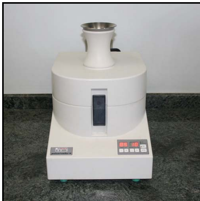
Figura 3.14 Moinho FRITSCH Pulverisette 14 utilizado para reduzir o tamanho de partícula das amostras
