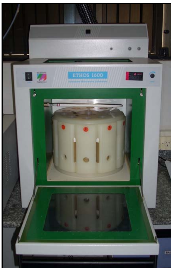
Figura 3.21 Forno de microondas Milestone ETHOS 1600 Microwave Digestion Labstation, utilizado na digestão das amostras de leite e ração bovina
