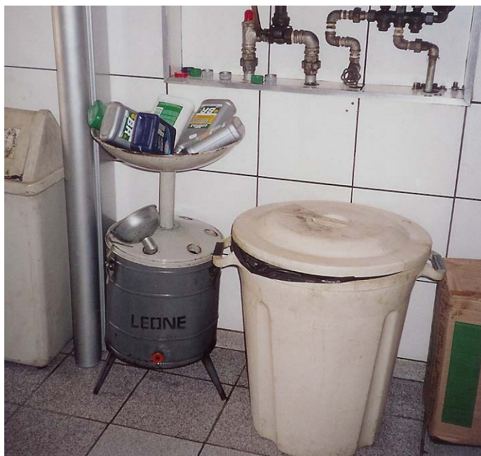
Figura 20 – Frascos de óleo escorrendo em coletor de óleo móvel. Tampas guardadas acima para posterior recolocação. À direita, recipiente com saco plástico – mantido em local coberto – para armazenamento temporário dos frascos.
