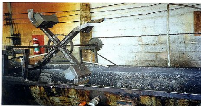
Figura 14 – Equipamento utilizado para lavagem de fragmentos plásticos.
