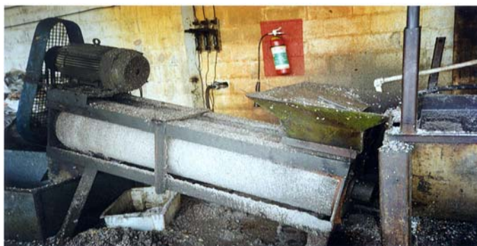
Figura 15 – Equipamento utilizado para secagem do material moído e lavado.
