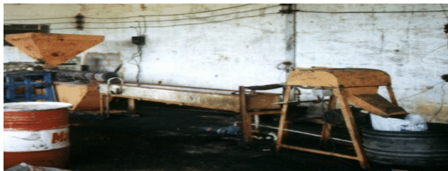
Figura 17 – Equipamento utilizado para Extrusão dos fragmentos plásticos.
