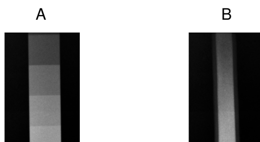
Figura 4 – A) Escala graduada 2,5; 2,0; 1,5; 1,0 mm de alumínio em barra; B) Escala contínua em óxido de alumínio de 0 a 4 mm utilizada para teste
