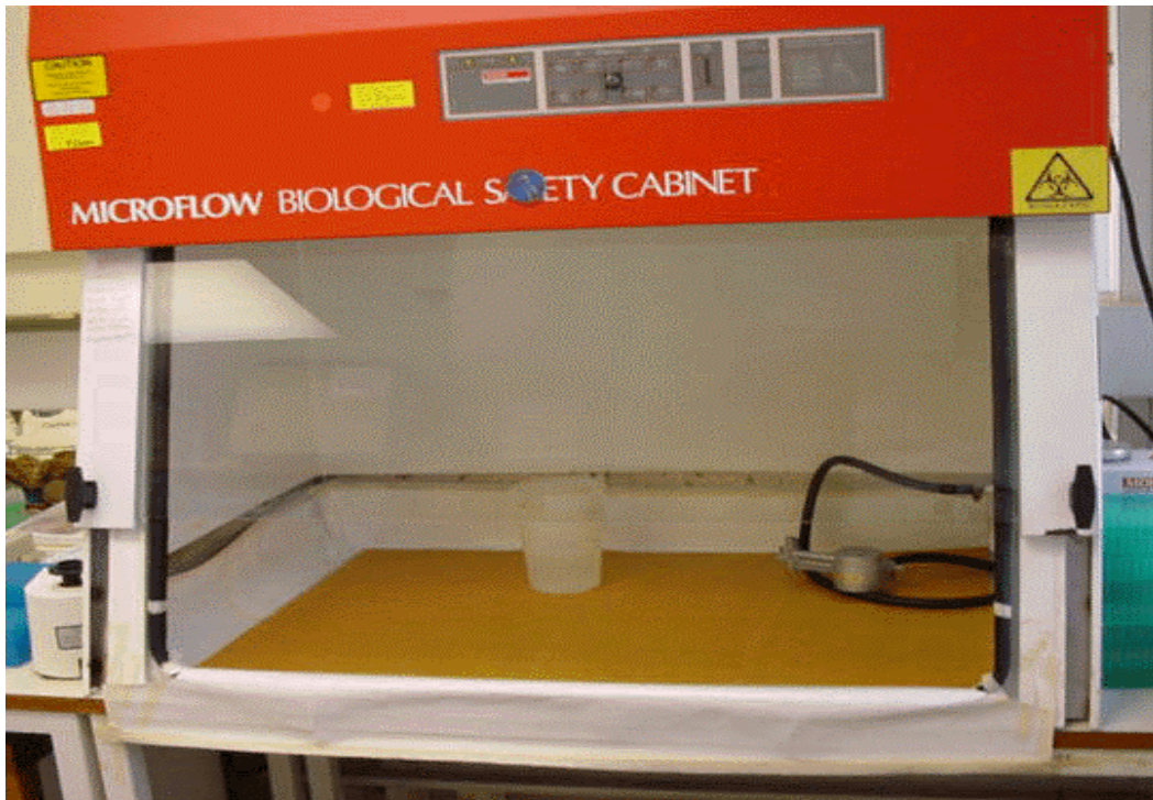
Figura 4.1 - Cabine de Biossegurança Classe I
