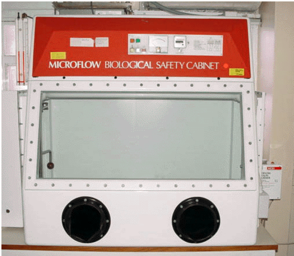
Figura 4.7 - Cabine de Biossegurança Classe III
