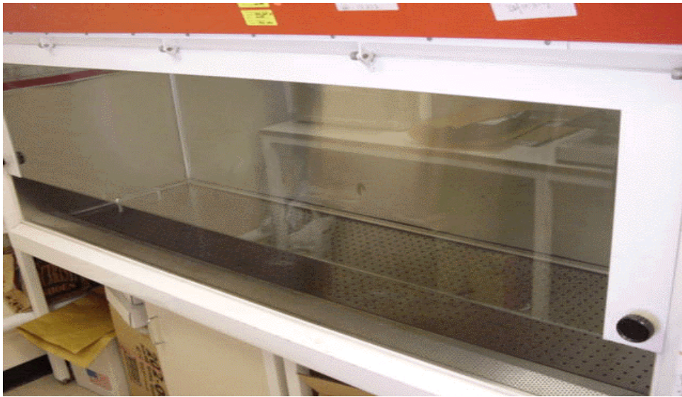
Figura 4.3 - Cabine de Biossegurança Classe II
