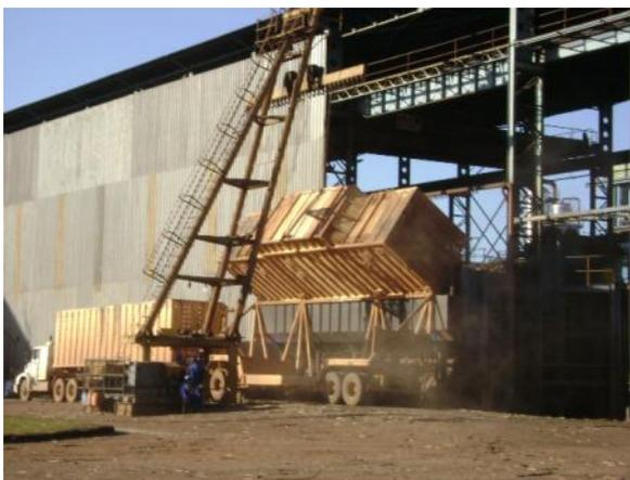
Figura 26 – Tombamento do semi-reboque
