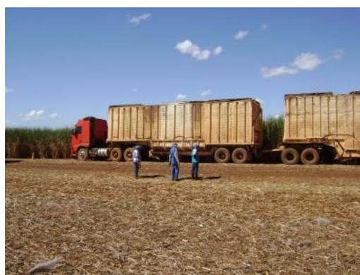
Figura 19 – Conjunto Cavalos mecânico mais semi-reboque
