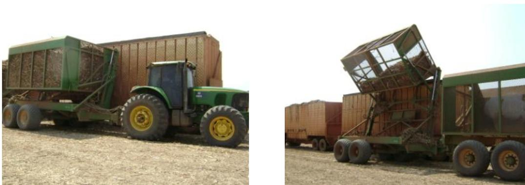
Figura 25 – Tratores transbordos carregando o semi-reboque.
