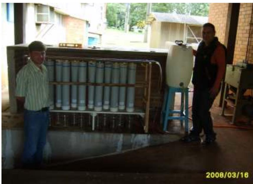
FIGURA 2 - FOTO DO PERMEÂMETRO
