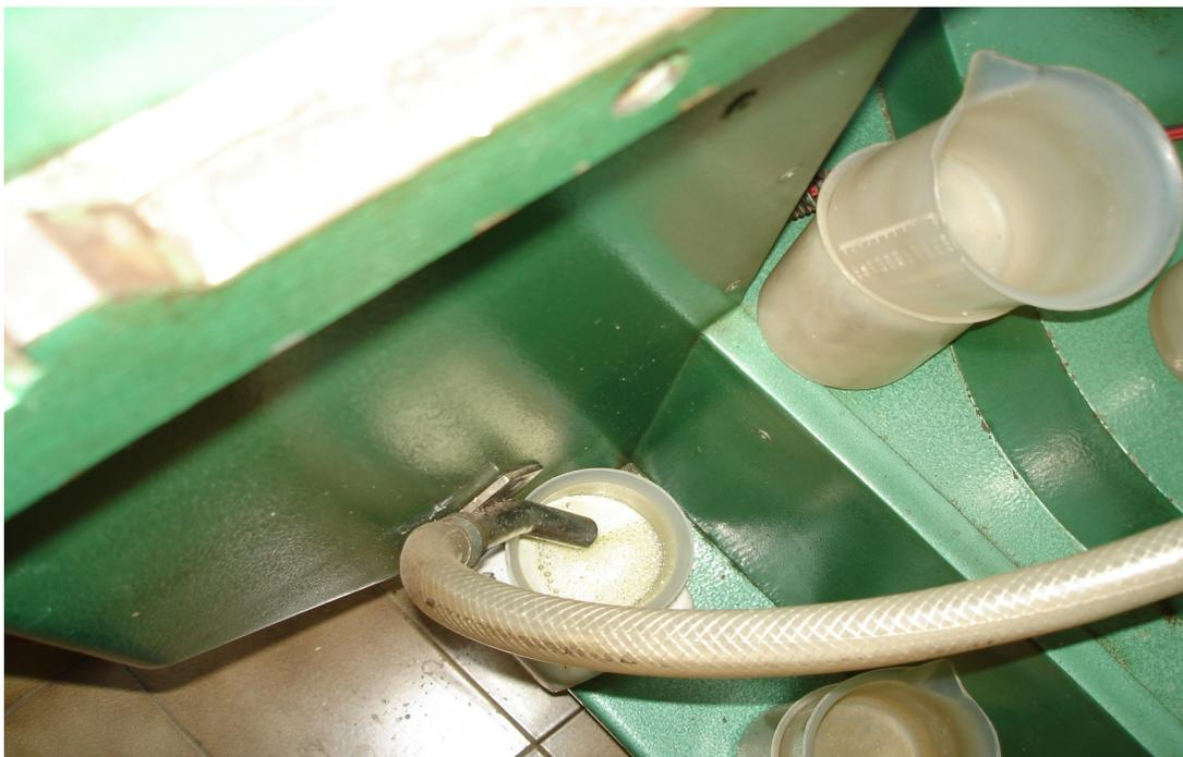
Figura 5. Prensa hidráulica utilizada para extração do caldo; amostra de caldo de cana sendo recolhida em frascos de polietileno.
