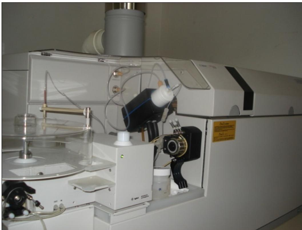
Figura 2. Espectrofotômetro de massas com Plasma Indutivamente Acoplado (ICP-MS). Agilent, modelo 7500ce.
