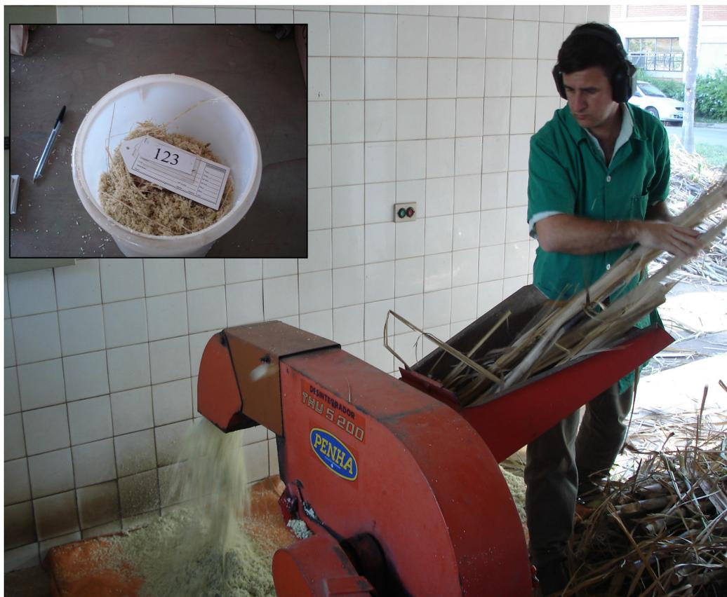
Figura 4. Colmos sendo triturados mecanicamente; no destaque, colmos desfibrados e identificado.
