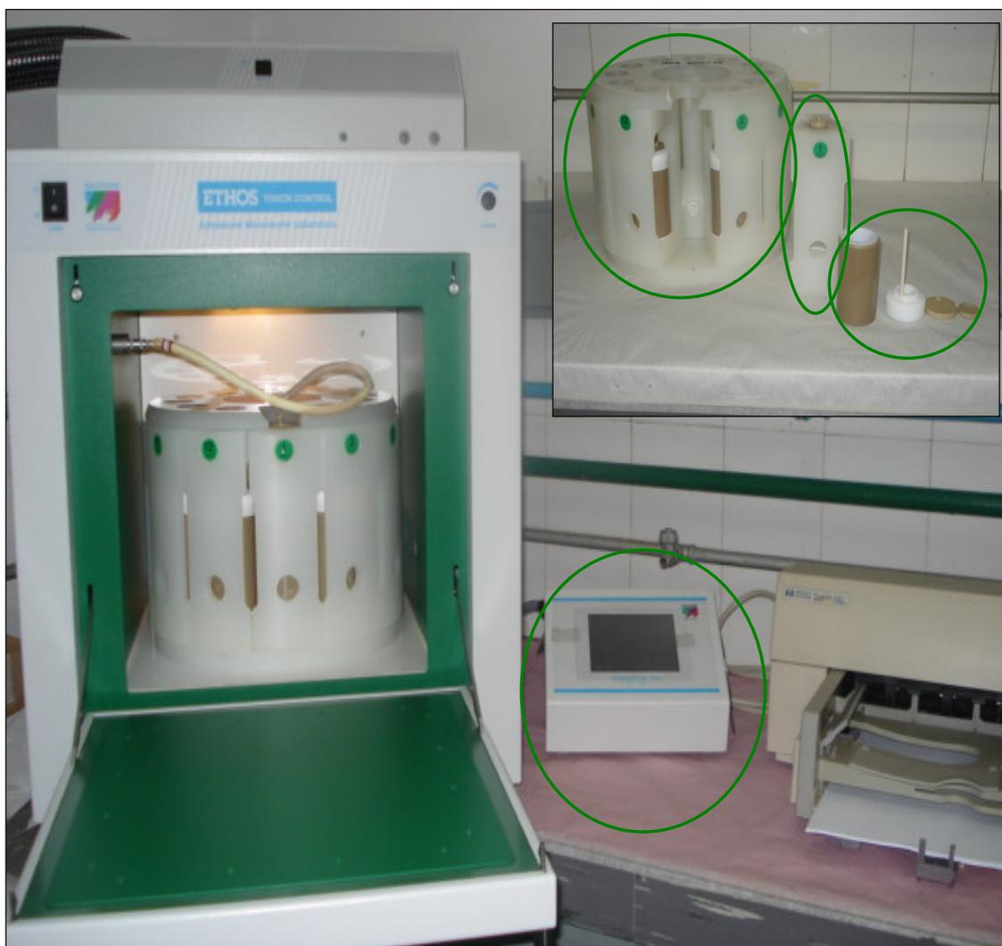
Figura 1. Micro-ondas Milestone, modelo Ethos TC Plus Microwave Labstation e computador acoplado. No destaque, rotor do micro-ondas para 12 monoblocos; monobloco; tubo reacional de referência com termopar.
