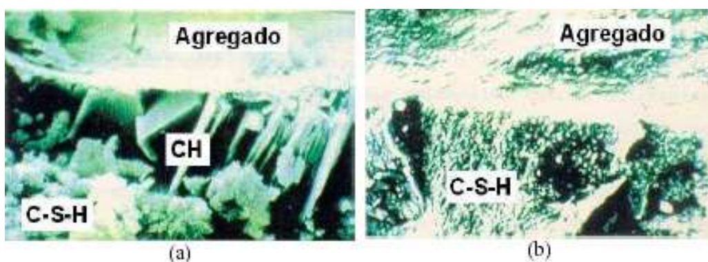
Figura 9: (a) zona de transição pasta/agregado de um concreto convencional típico. (b) zona de transição pasta/agregado de um concreto de alta resistência (MONTEIRO, 1993, apud DAL MOLIN, 1995).
