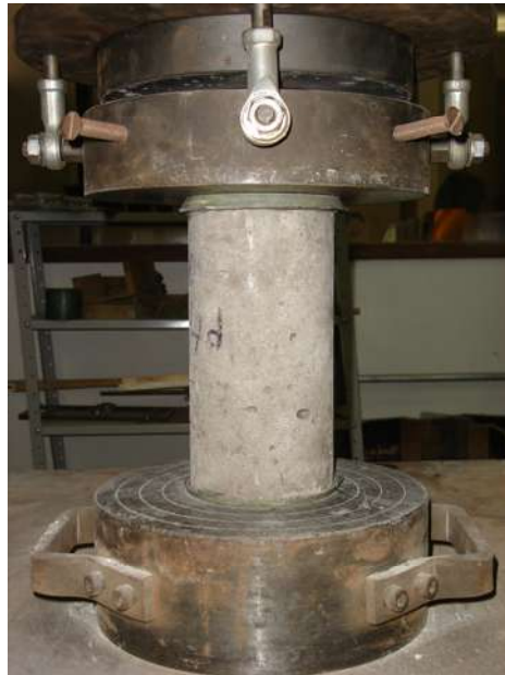
Figura 28: aplicação do pré-carregamento nos concretos
