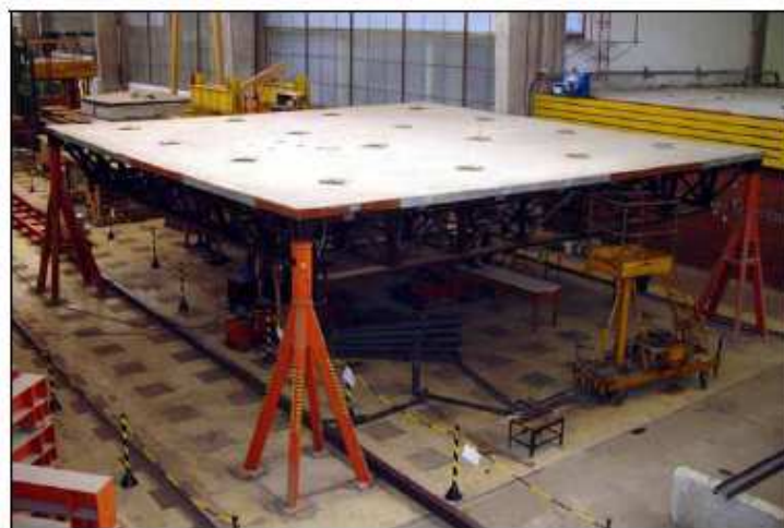
Figura 2.2 – Reticulado espacial composto utilizado por Varela (2004).
