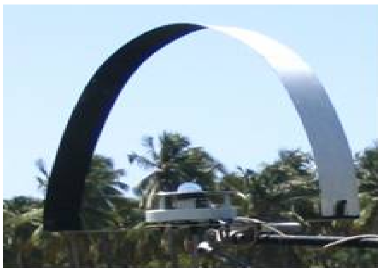
Figura 5 - Piranômetro Kipp e Zonen equipado com anel de sombreamento para medir a radiação solar difusa ( R_d ).
