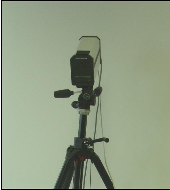
Figura 2 – Câmera Qualisys ProReflex MCU 240
