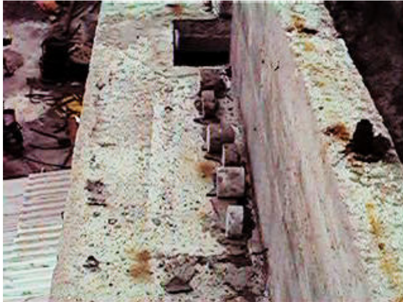
Figura 7.5 - Testemunhos expostos com face vertical exposta em posição similar a face vertical do paramento do cais (GUIMARÃES, 2000)
