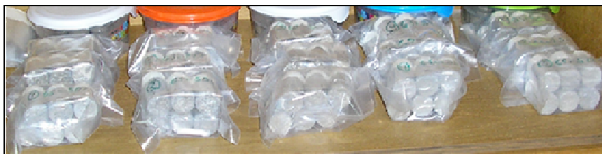
Figura 5.1 - Corpos de prova de argamassa peneirada dos cinco traços de concreto estabilizado para graus de saturação de aproximadamente 50%, 75% e 90%
