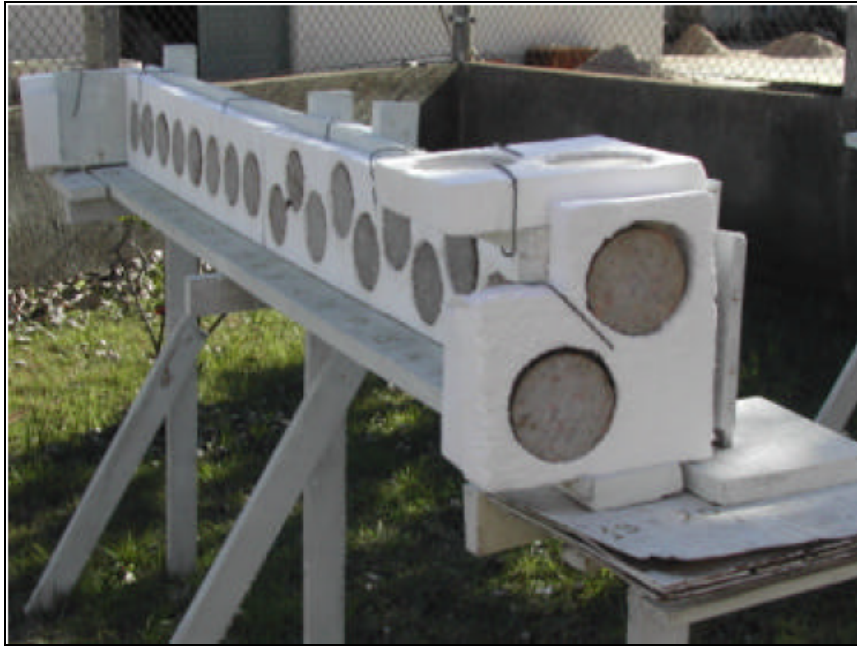
Figura 5.4 – Rack com testemunhos para medição do GS em função da variação sazonal e do posicionamento geográfico
